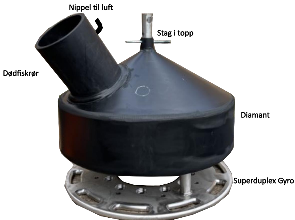
Figur 1: Illustrasjon av gyro med dødfiskdiamant.
