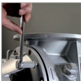
5. Skru i 2 bolter i hull med gjenger
