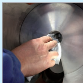
11. Rengjør åpning for akseltapp i begge endeplatene
