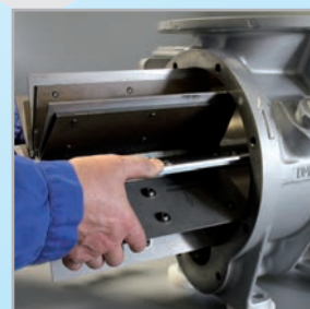
12. Støtt opp rotoren og skyv den inn
