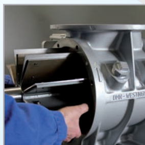
7. Støtt opp rotoren og trekk den ut
