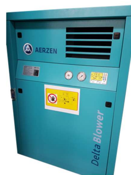
Bilde 1 Blåser med lydisolerende metallskap
