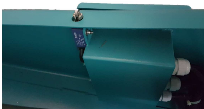
Bilde 23 Sikkerhetsfunksjon ved fjerning av toppdeksel
